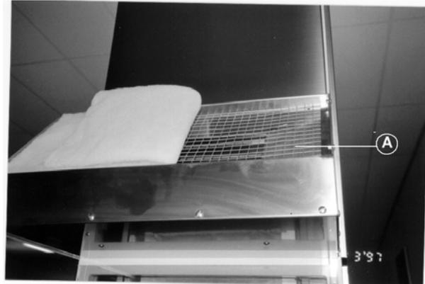
Le séchage est protégé par un thermostat maximal (A). Celui-ci désactive les éléments de chauffage en cas de surchauffe.
